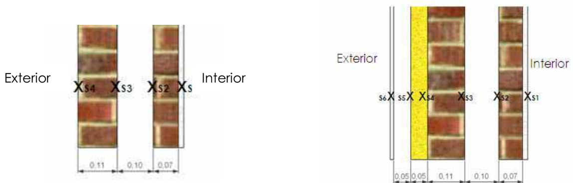
Figura 17. Esquema de la posición de los sensores de Temperatura (PT100) y fluxómetros ubicados en cada uno de los dos ejes por celda para medir la variables físicas que caracterizarán el elemento de fachada oeste, una doble fábrica de ladrillo en la fase 2 y doble fábrica de ladrillo y fachada ventilada tras su rehabilitación.
