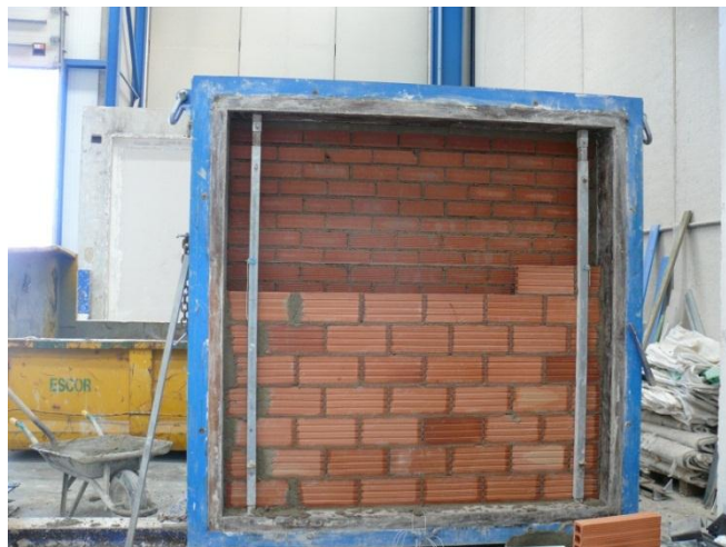
Figura 2.4 – Construcción de la muestra: muro de doble hoja de fábrica de ladrillo
