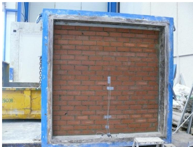
Figura 2.3 – Construcción de la muestra: muro de doble hoja de fábrica de ladrillo
