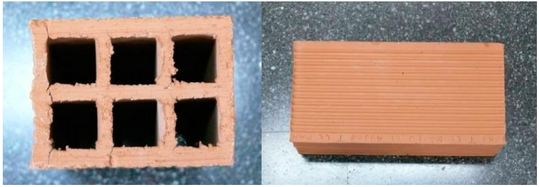
Figura 3.3 - Ladrillo Hueco Doble
