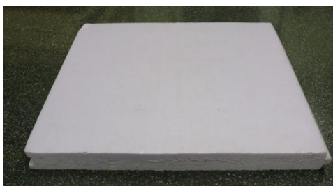
Figura 3.12- Poliestireno extruido XPS
