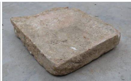
Figura 3.7- Ladrillo Macizo Aplantillado
