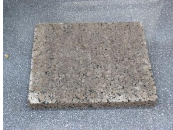
Figura 3.15- Corcho natural expandido
