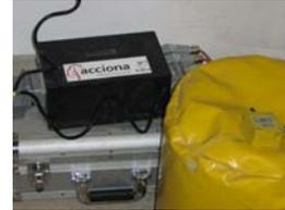
La curva de madurez permite controlar en tiempo real la evolución de la resistencia mecánica del hormigón en obra, en base a los condicionantes ambientales. De esta forma se calcula el tiempo óptimo de desencofrado, reduciendo considerablemente los plazos de entrega. Este desarrollo propio se está utilizando ya en obras de ACCIONA Infraestructuras.
