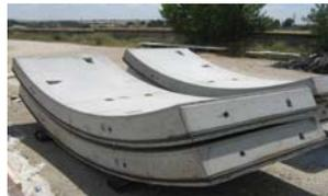
Dovelas reforzadas con fibra polimérica. Presentan alta resistencia a fuego, incrementando considerablemente la seguridad en túneles.
