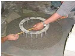
Desarrollo de hormigones autocompactables para estructuras con armaduras complejas
