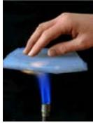
La especial estructura nanoporosa del Aerogel lo convierte en un aislante acústico y térmico de altas prestaciones combinándolo con la mayor ligereza posible. Desarrollando métodos eficientes en coste de fabricación
