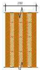
FORJADOS DE SUELOS Y ENTREPLANTAS. Se deben formar teniendo en cuenta las solicitaciones mecánicas de los paneles, por lo tanto las planchadas externas, al ser más cargadas, deben situarse en el sentido longitudinal del panel. Se pueden utilizar paneles de 3, 5 y 7 planchas.
