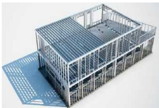
Esta técnica que como elemento básico comprende el perfil ligero, el Steel Framing, tiene la consideración de sistema diferenciado de otros, ya que, en base a unos elementos básicos determinados, sujetos a unas relaciones concretas que le son propias, dan cuerpo a una técnica constructiva, en este caso de base estructural.
