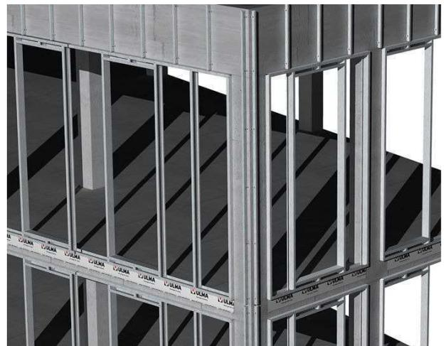
1. Estructura de hormigón o metálica donde se apoya el sistema
