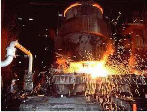
El acero es una aleación de hierro y carbono (máximo 2.11% de carbono), al cual se le adicionan variados elementos de aleación, los cuales le confieren propiedades mecánicas específicas para su diferente utilización en la industria. Los principales elementos de aleación son: Cromo, Tungsteno, Manganeso, Niquel, Vanadio, Cobalto, Molibdeno, Cobre, Azufre y Fósforo. Los productos ferrosos con mas de 2.11% de carbono denominan fundiciones de hierro.
