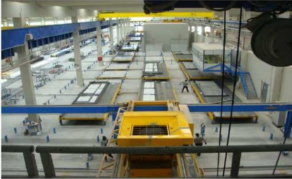
EL HORMIGON, para la realización de los distintos elementos estructurales, es elaborado por la empresa en la misma factoría de producción, con lo cual la empresa tiene el control de la totalidad del proceso de producción, desde el origen con la selección de la materia prima y los componentes, procedimientos intermedios y cuantas medidas necesarias para la consecución de las características y especificaciones finales del producto, así como el control de los plazos y tiempos de producción.
