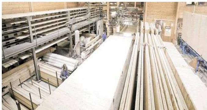
**MATERIA PRIMA.** La madera estratificada en cruz (KLH) se compone de láminas de madera de abeto rojo cruzadas que son encoladas y tratadas bajo alta presión de moldeo, hasta convertirse en placas de madera maciza de gran formato. En función de las exigencias tiene lugar la unión de 3, 5, 7 o más capas con un grosor máximo de 60 cm.
