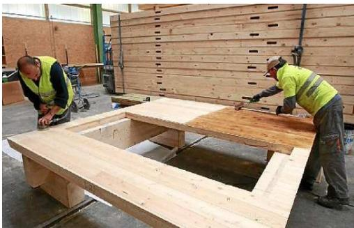
> EGO CLT™ y EGO CLT MIX™, son paneles de madera contralaminada de gran versatilidad, fabricados íntegramente en Egoín, que permiten la construcción de edificios diáfanos y que se adaptan perfectamente a su proyecto, sea obra nueva o rehabilitación. Con este material, además de construir edificios construimos puentes, ascensores, escaleras, torres
